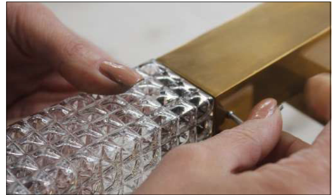
4. Screw the grain on the right side. Stringere il grano sul lato destro.
